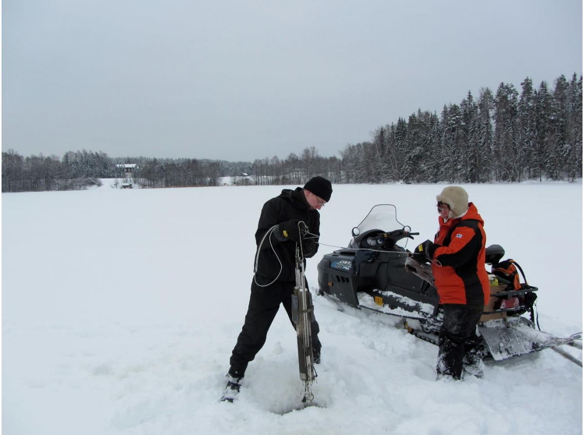
Kuva 4. Näytteenottoa Limnos-noutimella. Kuva © Veli-Pekka Salonen.
