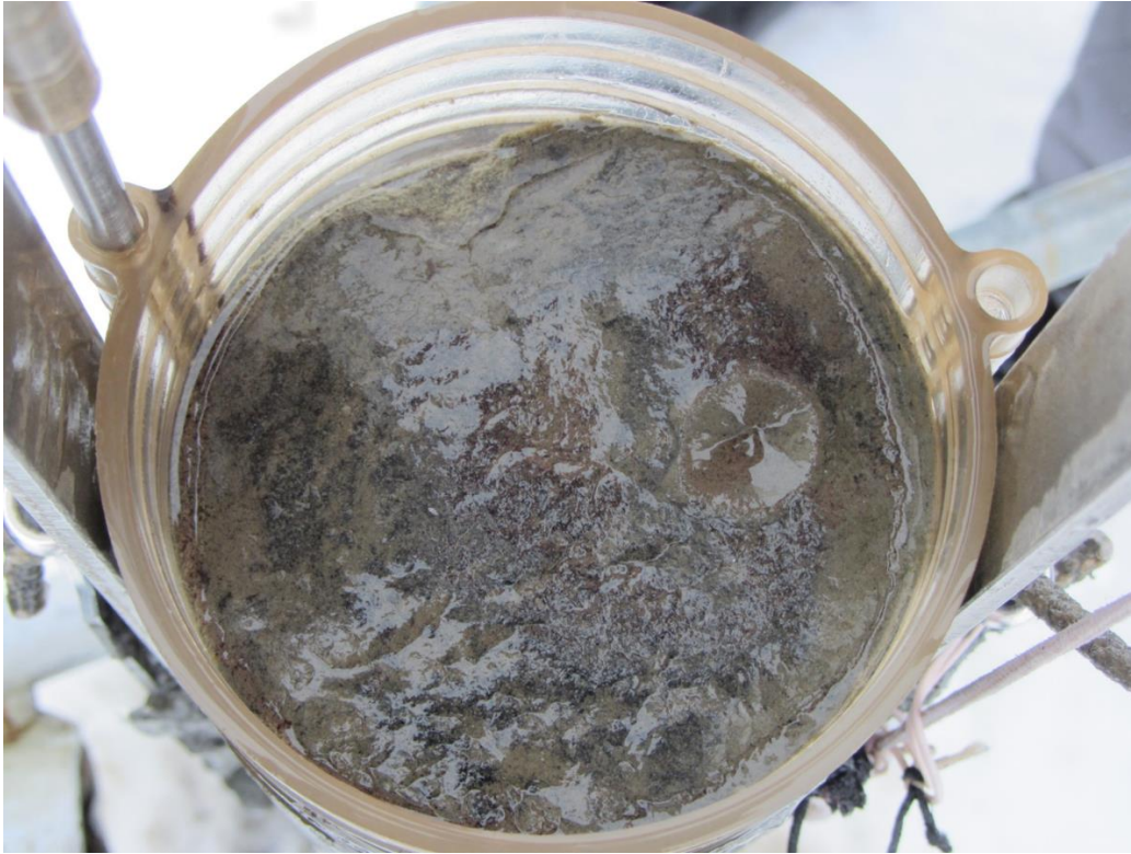
Kuva 6. Pintasedimentti jossa tummia sulfidilaikkuja sekä kaasunmuodostuksesta kertova kraatteri. Kuvassa on nähtävissä myös raudan punaruskeaksi värjäämää pintaa. Kuva © Veli-Pekka Salonen.
